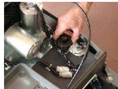
REGOLAZIONE DELLA SPAZZOLA CENTRALE SENZA ATTREZZI
